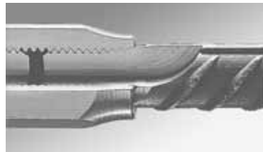
Przekrój skręconego połączenia
