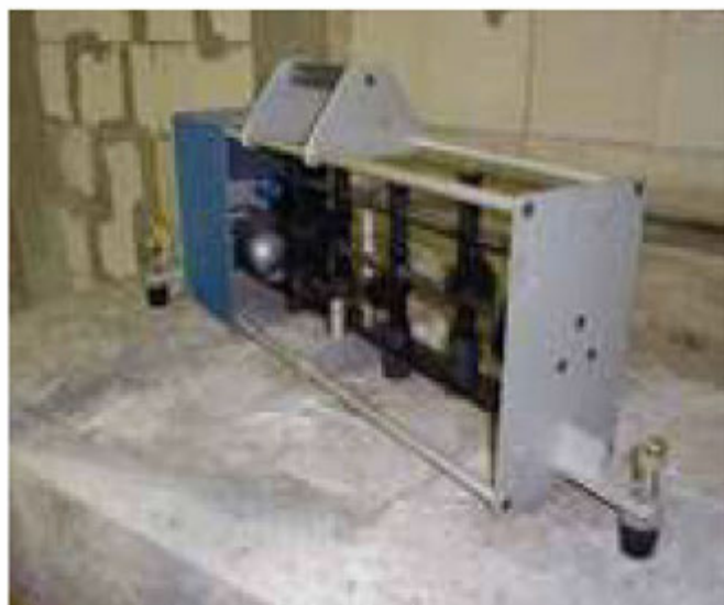
Normovací kladivový mechanizmus podľa DIN EN ISO 10140
