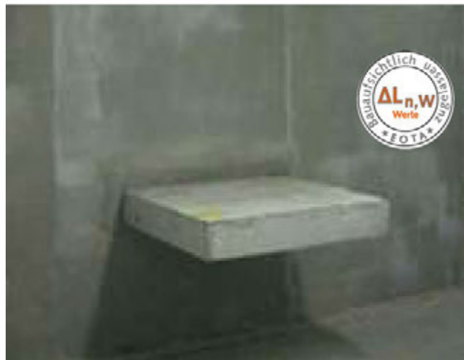
Skúšobňa podľa DIN EN ISO 10140 so zabudovaným prvkom
